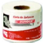
La cinta de refuerzo **Durock®** está fabricada con malla de fibra de vidrio polimerizada, es de 10 cm. de ancho (4") y se adhiere a la superficie del tablamento con compuesto para juntas. Se presenta en rollos de 45 ml.
